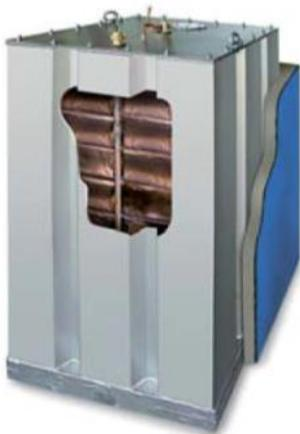
Als Speichermaterial werden sogenannte Phasenwechselmaterialien (PCM, Phase Change Materials) eingesetzt, die thermische Energie verlustarm und mit vielen Wiederholzyklen über lange Zeit speichern können, da deren latente Schmelz-, Lösungs- oder Absorptionswärme wesentlich größer ist als die Wärme, die sie aufgrund ihrer spezifischen Wärmekapazität speichern können (BINE 2009; Kruse/Friedrich 2002).
